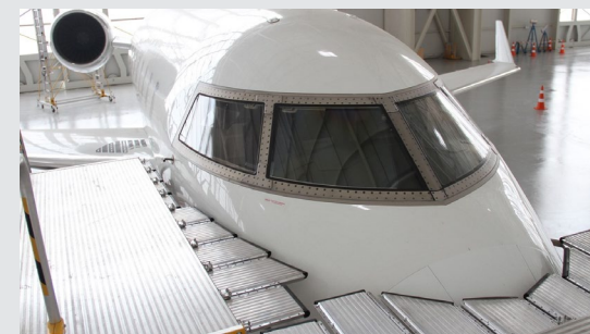
Uitschuifbaar platform met beschermrubbers
