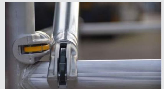
Kleurverschil tussen de horizontaal- en de diagonaalschoor
